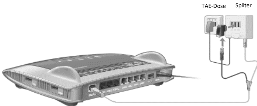
Abbildung 3: Router-Anschluss mit analogem Telefon
