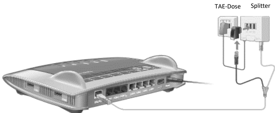
Abbildung 3: Router-Anschluss mit analogem Telefon
